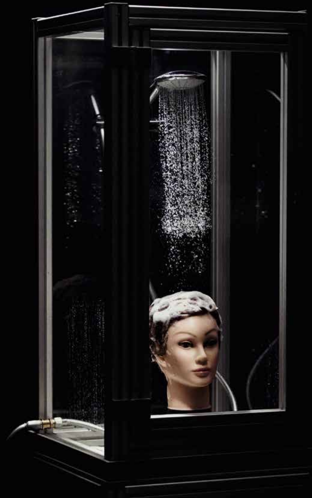
In Bensing's Shower Lab lassen sich die Vor- und Nachteile verschiedener Strahlarten testen.
